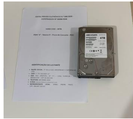
Figura 12 – Hard Disk – 06TB usado no Gravador de Imagem – NVR – 16 canais
